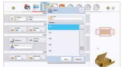
Les paramètres de chaque découpe (par ex. la longueur, la largeur et la hauteur) sont enregistrés sous la forme d'une **référence de carton**. Les découpes récurrentes peuvent être facilement sélectionnées et produites sans avoir besoin de saisir à nouveau les paramètres.
