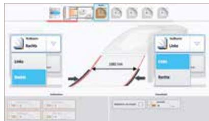
Grâce à une **sélection libre de la ligne zéro**, les découpes peuvent être réalisées des deux côtés de la machine de découpe de cartons.
