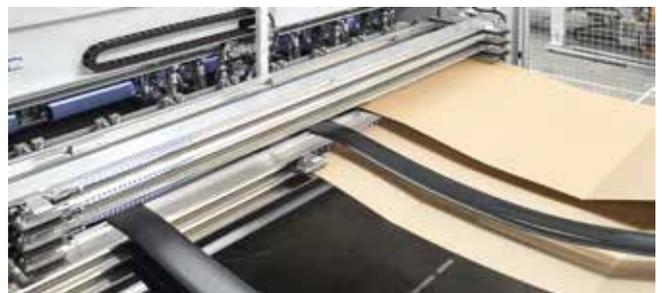
Le **changeur de cartons en bandes** est un système de changement automatique pour les largeurs de bande sans fin qui comprend jusqu'à six compartiments.
