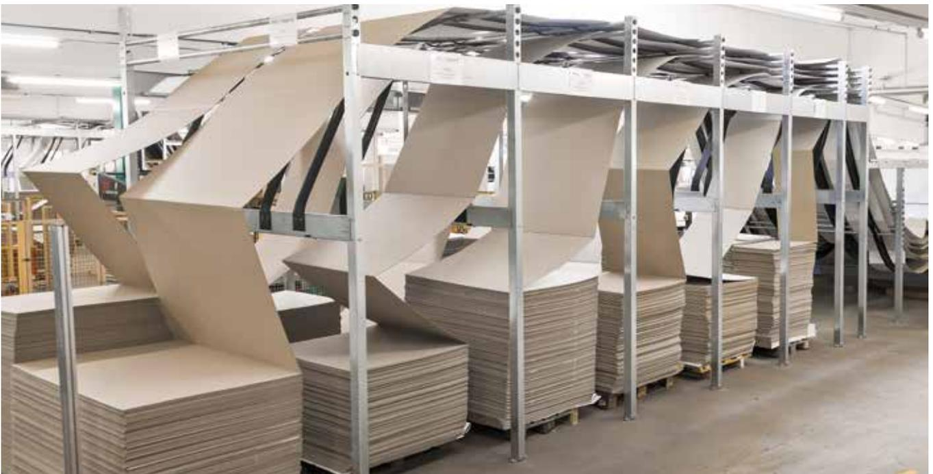
En mode de fonctionnement **Side-by-Side**, le compartiment d'alimentation des cartons est agrandi d'une largeur de bande supplémentaire, de sorte que, dans le cas d'un système de changement à 6 emplacements, jusqu'à 12 largeurs de bande puissent être accessibles individuellement.
