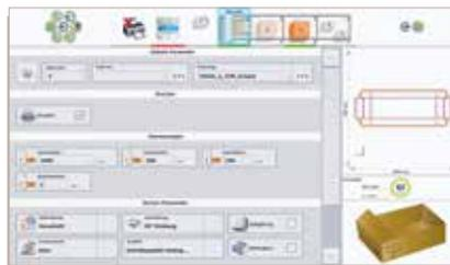
L'**optimisation des chutes** permet de calculer la position idéale d'un modèle de carton sur le carton en bandes et d'ajuster son modèle de coupe de telle sorte que la quantité de chutes soit réduite à un minimum.
