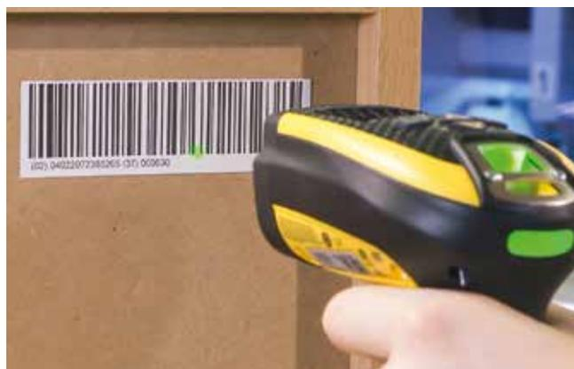
Grâce à la **commande par codes-barres**, la saisie des données est un jeu d'enfant. Il suffit de scanner le code-barres et une référence de carton comprenant toutes les données nécessaires est transmise à la machine de découpe de cartons.
