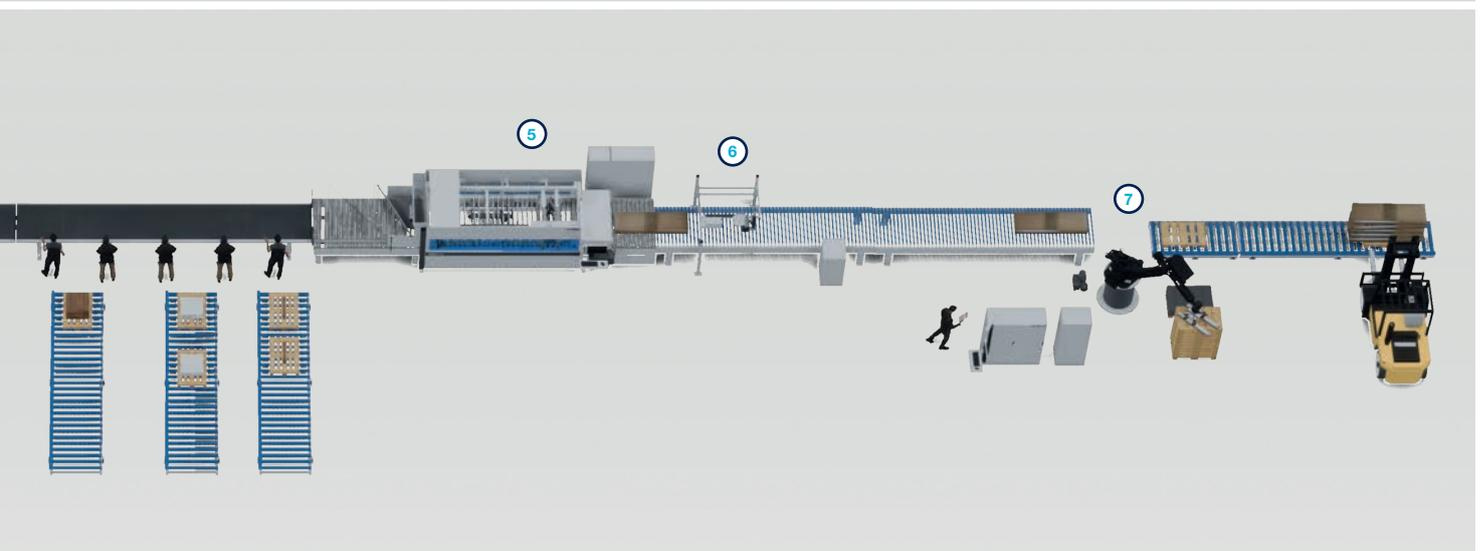
**3 PAQTEQ Integration in Verpackungsline mit Roboterabstapelung**
