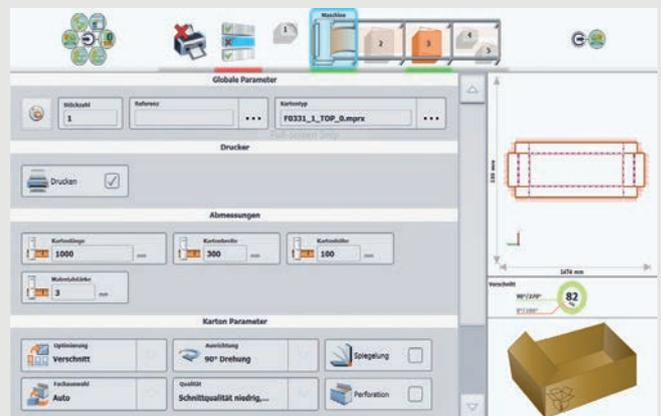
Die **Verschnittoptimierung** errechnet die ideale Position für ein Kartondesign auf der Endloskartonage und richtet dessen Schnittmuster so aus, dass möglichst wenig Abfall entsteht.
