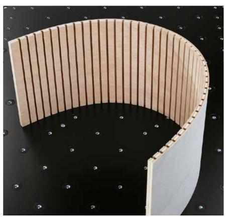
La coupe créée des tensions pouvant influencer la qualité de la cote et de la coupe. La coupe sans tension permet d'y remédier. Des pré-coupes ciblées peuvent être prévues lors de l'optimisation pour supprimer la tension du matériau. Et grâce à la fonction découpe, les découpes de panneaux et les rainures arrêtées pour éviers ou découpes de portes, par exemple, sont réalisées en même temps.
