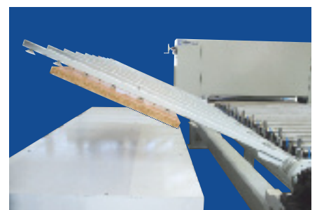
Rotation et empilage des panneaux légers
