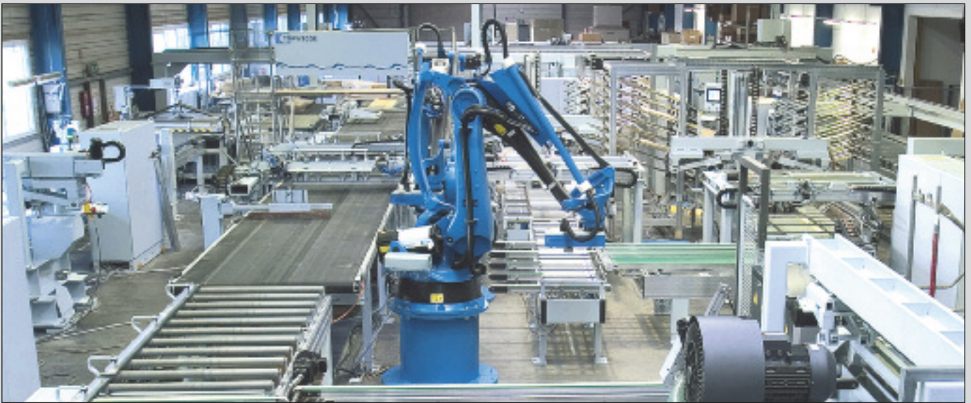
Installation pour la fabrication de panneaux légers avec magasin à traverses automatique et station de dépose de cadres automatique
