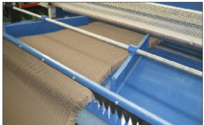
Canal d'expansion pour papier à alvéoles hexagonales
