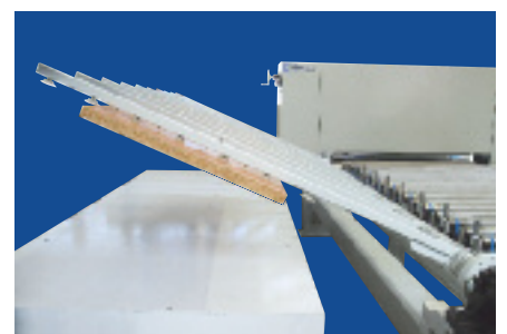
Ribaltamento e scarico di pannelli leggeri
