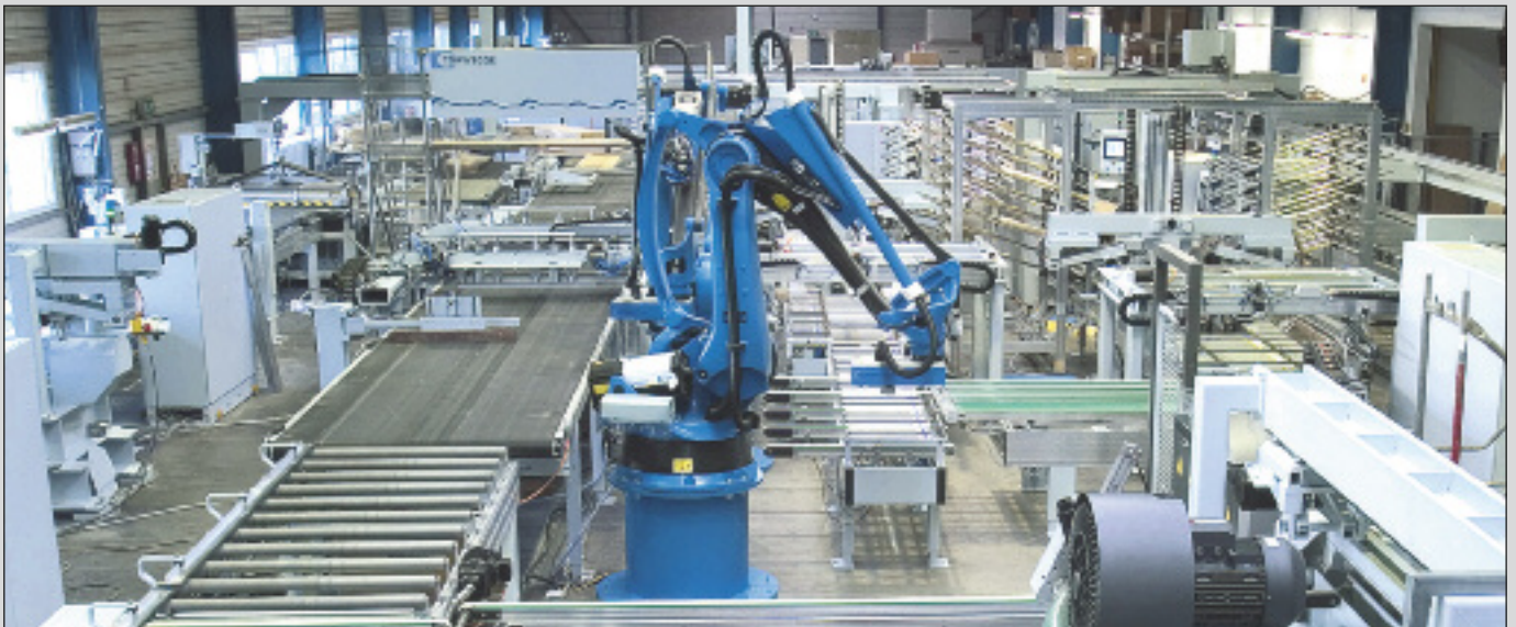
Impianto per produrre pannelli leggeri con caricatore automatico della struttura e stazione di deposito automatico dei telai
