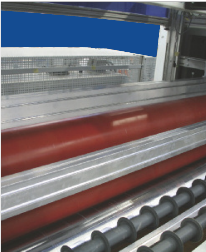
Rulli di applicazione della colla
