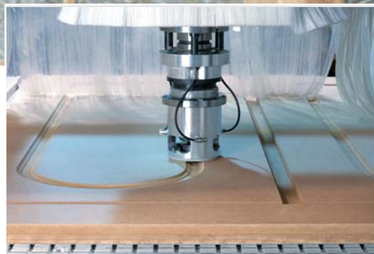
Grupo de fresado con palpación vertical para el mecanizado de alta precisión de, p. ej., frontales de muebles
