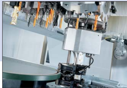
Des résultats de qualité – Une qualité des chants optimale est obtenue grâce à l'agrégat palpé combiné affleurage-finition qui utilise l'axe C et le système pneumatique. Il s'agit d'une technique HOMAG brevetée
