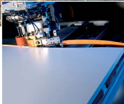
Agrégat d'encollage EasyEdge pour un encollage de chants rationnel pour les petits lots. Utilisation universelle pour: ● chants ABS ● chants PVC ● chants stratifiés
