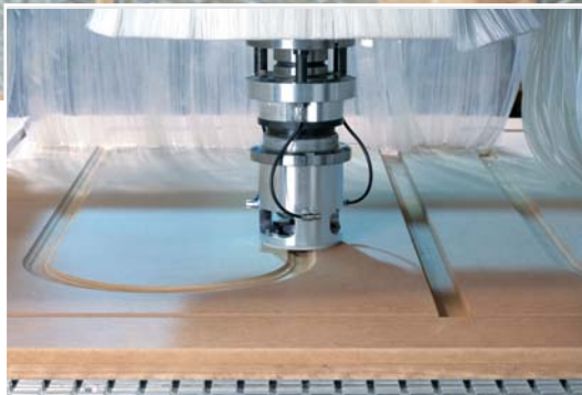
Agrégat de fraisage vertical palpé pour les usinages précis, les façades de meubles, par ex.
