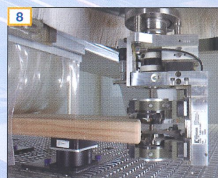
8 Interpolierende C-Achse 360°: um die Aggregate in beliebigem Winkel drehen zu können, inkl. Druckluftübertragung in die Aggregate (z. B. für getastete Aggregate)
