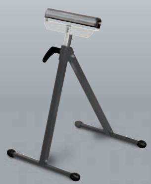
MS 3 R Mit Rollenauflage und Handgriff zur Schnellverstellung. Tragfähigkeiten: niedrigste Position - 90 kg mittlere Position - 60 kg höchste Position - 45 kg
