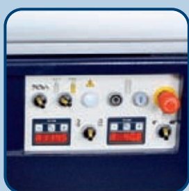
Optional · motorische Frässpindelhöhenverstellung und -schwenkung · mit Digitalanzeige der eingestellten Werte für eine hohe Wiederholgenauigkeit
