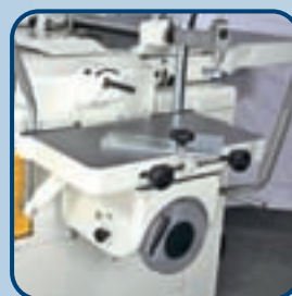
Abb. zeigt FS 41 elite S TERSA Digital mit motorischer Höhenverstellung und Digitalanzeige
