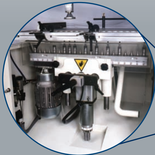
Zylinderrundstangenführung des Bohraggregats
