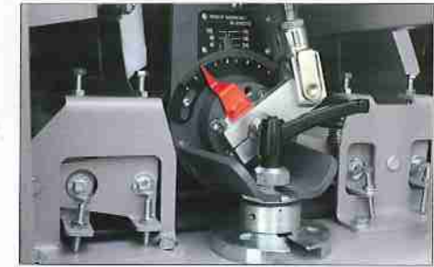
| MECHANISCHE KORREKTUR DER ARBEITSHÖHE ABHÄNGIGKEIT VON DER SCHLEIFBANDKÖRNUNG
