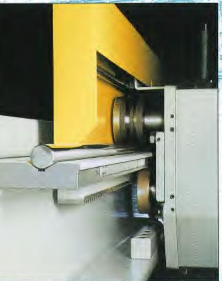
• Guida di precisione doppia dello spingitore a programma • Robusto servo-comando AC con cremagliera • Rulli prismatici senza manutenzione su alberi di guida temperati e rettificati • Sistema di misura lineare senza contatto
