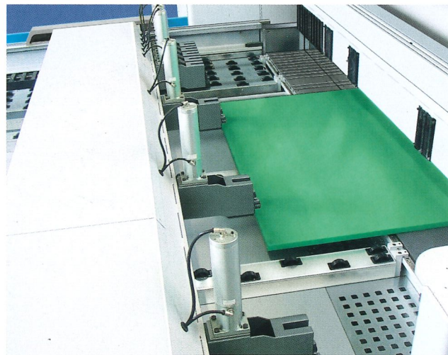
Streifenschneiden von Kunststoffplatten. Ripping of plastic panels.
