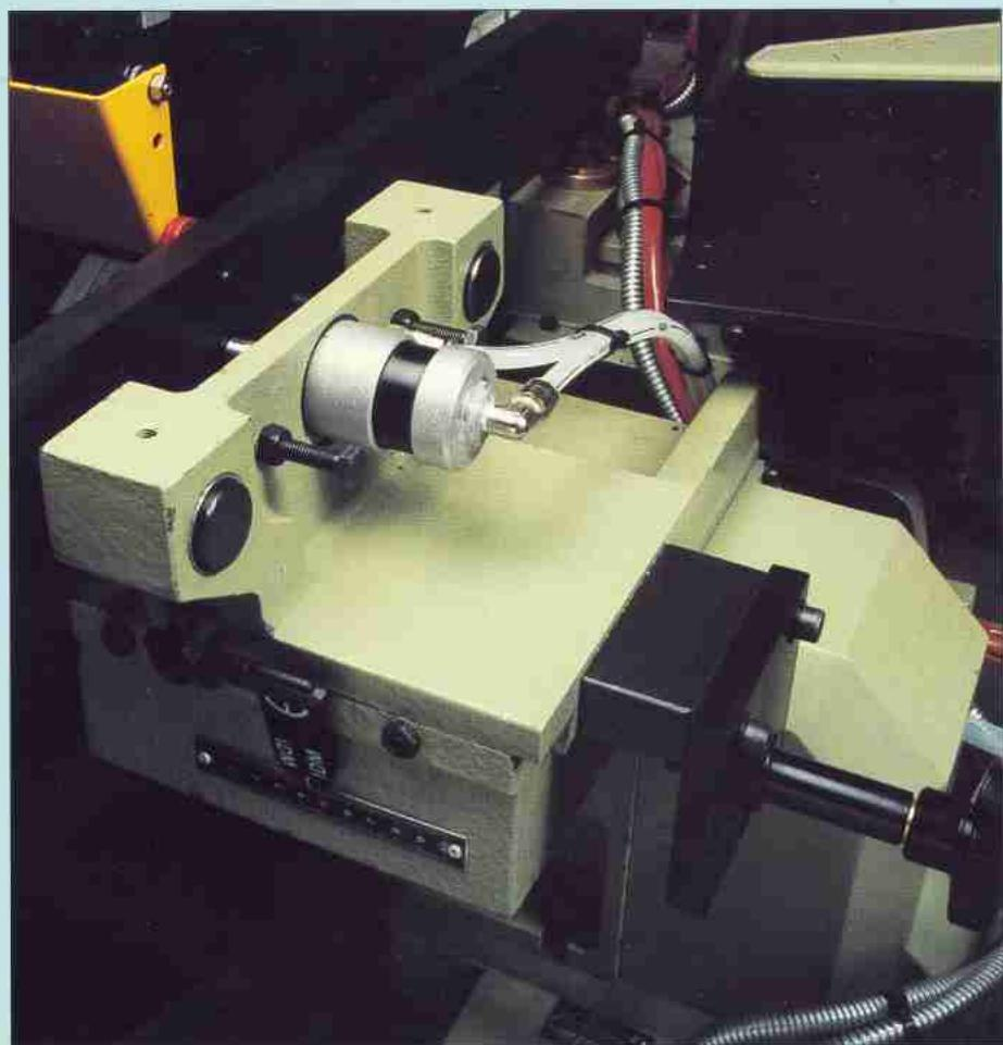
Nelle macchine bilaterali l'entrata ed uscita regolare del pezzo in macchina viene assicurata da un piccolo transfer ricoperto di tasselli in gomma.
