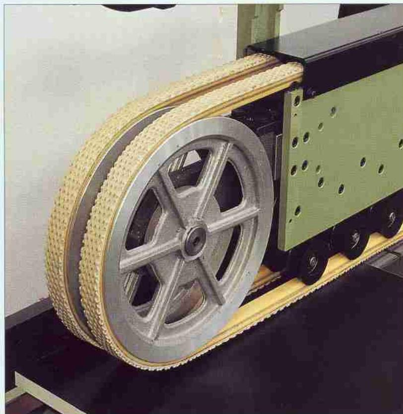
Bei den doppelseitigen Maschinen wird der gleichmäßige Ein- und Auslauf der Werkstücke durch einen kleinen Transfer mit Gummibeschichteten kettengliedern gewährleistet.
