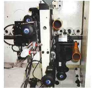
Groupe racleur de chant avec dispositif de décrochage rapide de l'outil Gruppo rascador con dispositivo de desplazamiento rápido de herramienta
