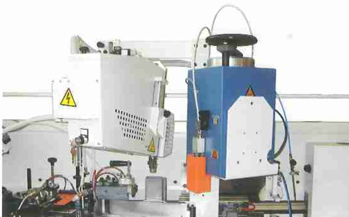
Quick melting and glue pot change over system (EVA-PUR) Système de changement rapide entre préfuseurs pour colle EVA et PUR avec changement rapide de bacs à colle Schnellaustauschsystem zwischen Vorschmelzern für EVA und PUR mit schnellem Austausch der Leimwannen
