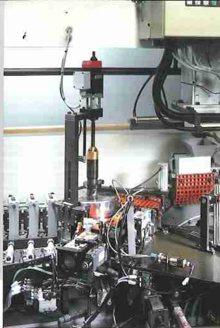
Grupo de encolar + tramo de presión
