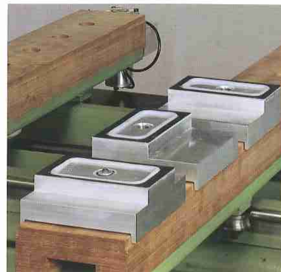
Schmalsauger für min. Werkstückgröße 70 x 140 mm.
