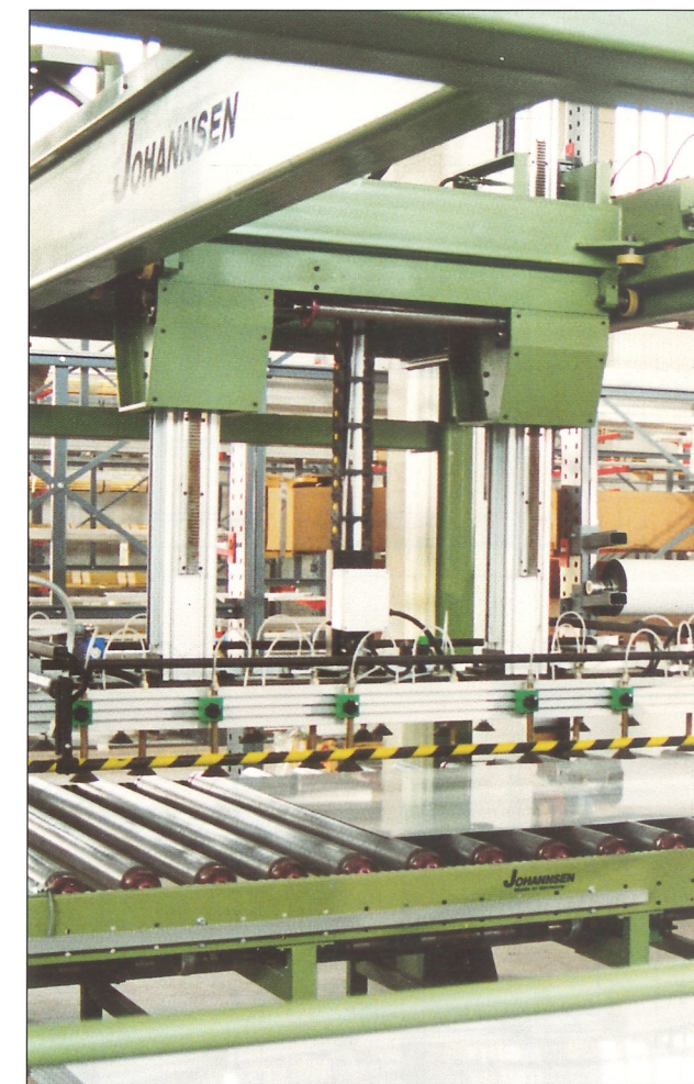
Die JOHANNSEN-Vakuum-Technik: Sauger, Greifer, Vakuumpumpe, Steuerventile, Filter, Manometer und Vakuumregler garantieren einen sicheren und festen Transport Ihrer Produkte. Je nach Oberflächenbeschaffenheit, Form der Werkstücke, Gewicht und Größe Ihrer Produkte bietet JOHANNSEN die passenden Handlingsmodule.
