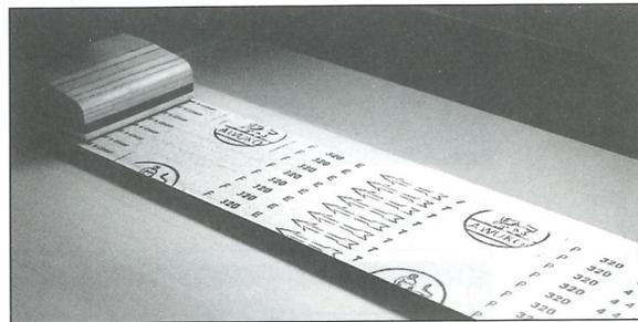
**Beleuchtung** hinter der Bandabdeckung zur besseren optischen Kontrolle des Schleifergebnisses
