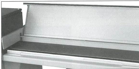
**Schleifauflage** zum schnellen Schleifen oder Brechen von Kanten
