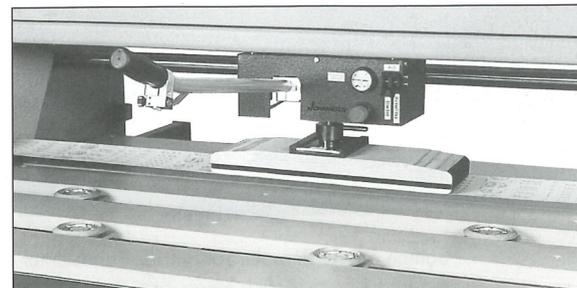
**Vakuum-Saugspanneinrichtung** - damit Ihr Werkstück auch sicher gehalten wird
