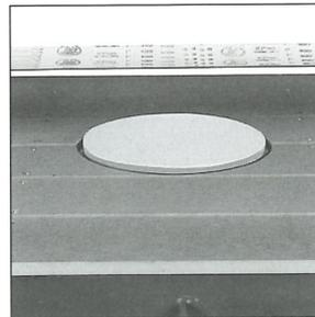
**Drehhubteller** zum Wenden großer Werkstücke und leichtem Abnehmen schwerer Werkstücke
