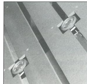
Die Vakuumsauger liefert Johanssen je nach Kundenwunsch mit 4 oder 6 Saugelementen. Die Vakuumpumpe und die Verteilerbatterie befinden sich unterhalb des Maschinentisches. Das Vakuum wird bedienerfreundlich unterhalb der Handstange ein- und ausgeschaltet.
