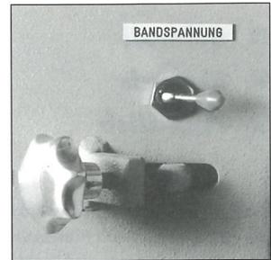
**Pneumatische Bandspannung** erspart das Nachspannen des Schleifbandes
