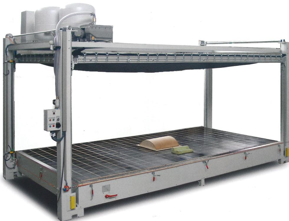
■ Allseitig offene, an vier Säulen geführte, großformatige Sonderpresse für sehr große und komplizierte Bauteile. Mit großvolumigem Vakuumreservoir, regelbarer Vakuumkapazität und Membranschnellwechselsystem.
