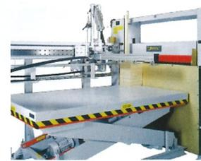
Automatische Materialzuführung mit Einschubvorrichtung.
