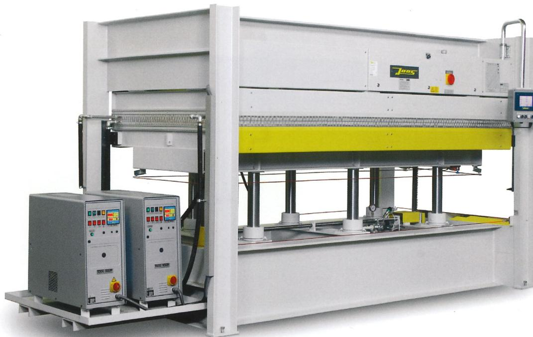
Maschine mit eigener, unabhängiger und wirtschaftlicher Warmwasserheizung und SP-Steuerung zur automatischen Druckermittlung.
