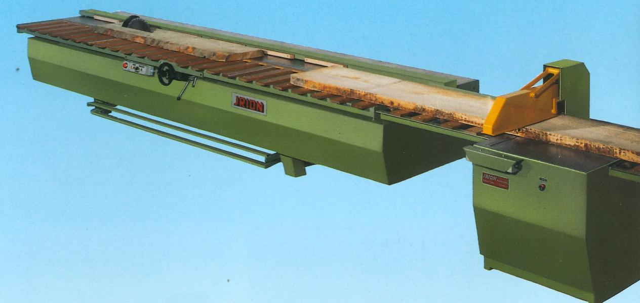
Durch die Anordnung einer unserer Pendel- oder Kappsägen, links oder rechtsseitig der HFS-170 erreicht man die optimale Lösung eines rationellen Zuschneidens. Zeitaufwendiges und mühevolles Abstapeln des Schnittgutes zwischen Quer- und Längsschnitt entfällt bei diesem fortschritten Konzept vollumfänglich.
