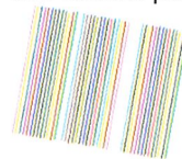
Traces du ponçage en diagonal
