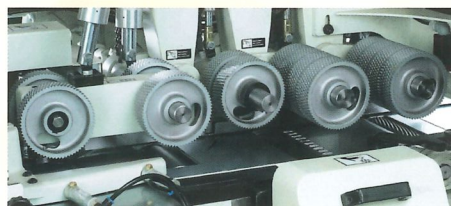
Schwerer Einzug, oben und unten Pneumatische Andruckrollen links
