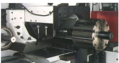
Hydro-Spindel bis Arbeitsbreite 325 mm
