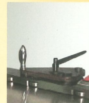
Rechtes Einlauflineal mit Gleitrollen
