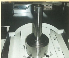
Vertikalspindeln bis 230 mm mit Schnellspannmutter
