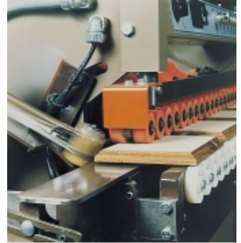
Fräsen, Schleifen und Dekorieren in einem Arbeitsgang Shaping, sanding and decoration in one working step
