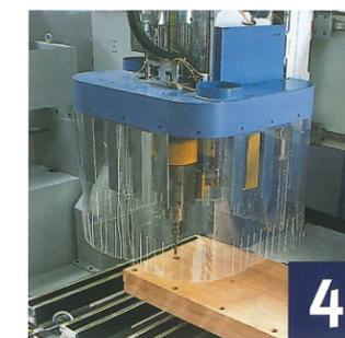
Staub- und Spänefangkorb am Aggregat CNC-höhenverstellbar
