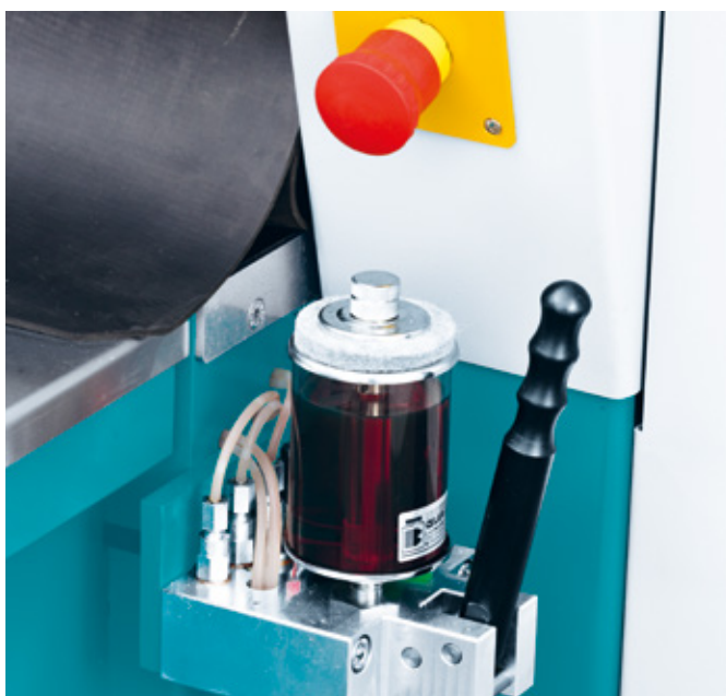
Engrase centralizado mediante bomba de aceite
