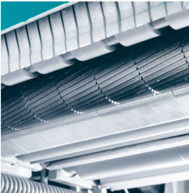
Cilindro de alimentación de acero con dentado en espiral
