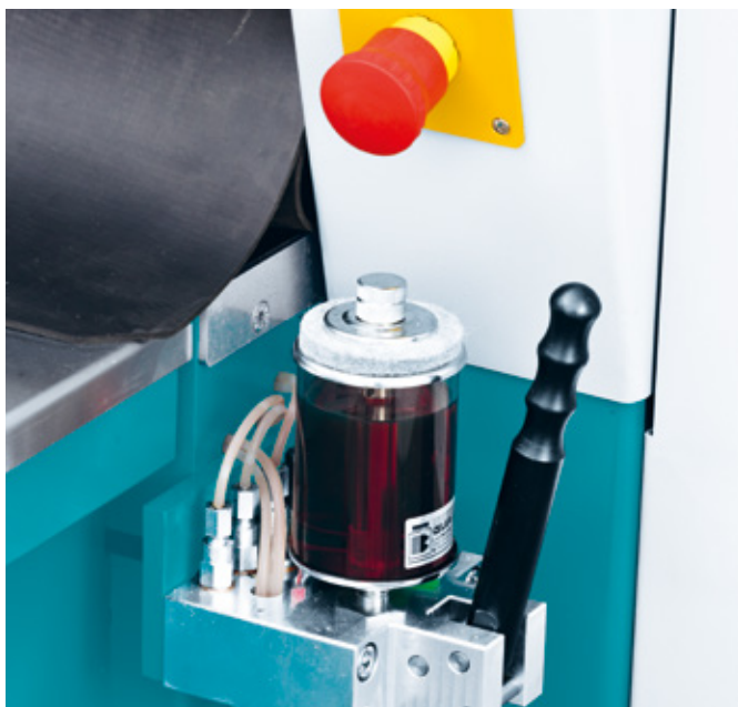
Centralne smarowanie przez pompę olejową
