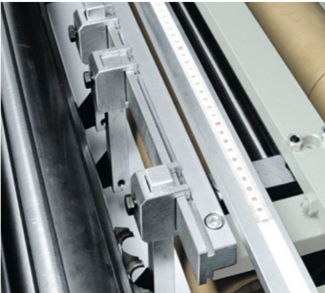
Dispositivo di pressione speciale per lavori di profilatura | T4540
