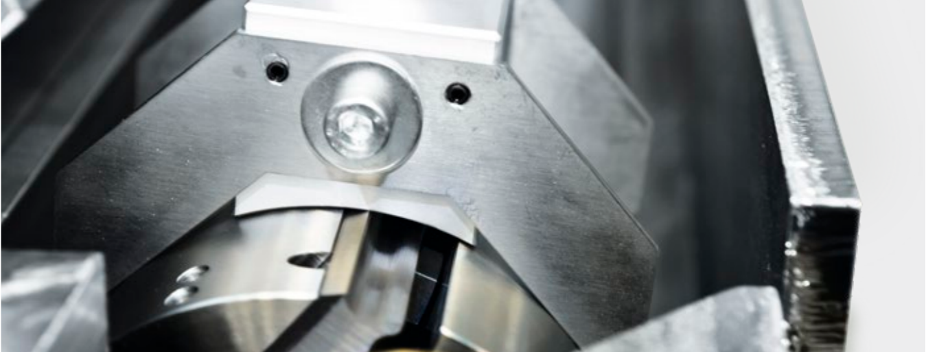
Albero portalama con chiavette di serraggio con dispositivo di regolazione | T543
