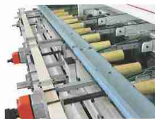
Quick speed discharge track system and piece deposit guide blade(OPT.) Система погрузки с высокоскоростной цепной лентой и укладываемой пластиной (OPT.)
