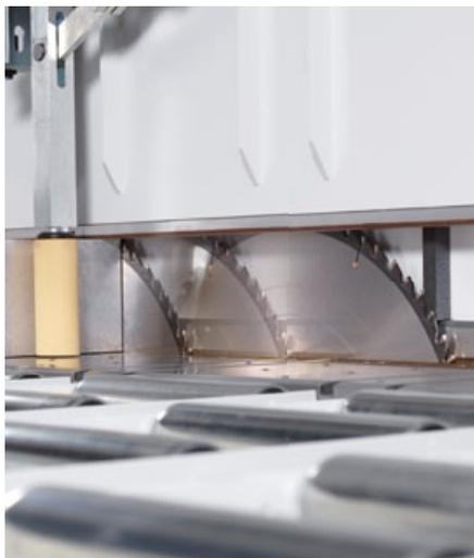
Geteilter Druckbalken für perfekte Absaugergebnisse beim Materialanschnitt.
