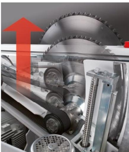
Stufenlose Sägeblatt-Höheneinstellung auf geschliffener Trapezführung mit spielfreier Kugelumlaufspindel.
