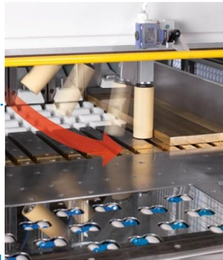
Pneumatisch gesteuerte Anpresseinheit für Streifenschnitte.
