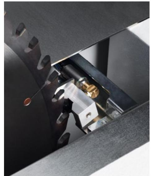
Im Sägewagen integriertes Minimalmengen-Schmiersystem (MMS) für das Hauptsägeblatt.
