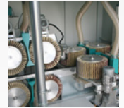
Vollautomatisches und allseitiges Schleifen aller Fenstertypen IV 70 bis 105 und Holz-Alusysteme.
