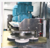
Das Profi Disk Aggregate als optionales Zusatzaggregat am Ein- und/oder Auslauf der Maschine
