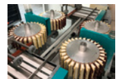
Alle Schleifaggregate oszillieren unter Berücksichtigung der Teilemaße. Somit ist sichergestellt, dass die Schleifmittel immer vollständig genutzt werden.
