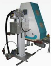
RB300 Aggregat mit motorischer Höhenverstellung und Oszillationseinheit
