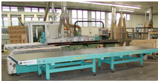
Automatisationslösung Profiturn S zum Umfälen von Flügelrahmen
