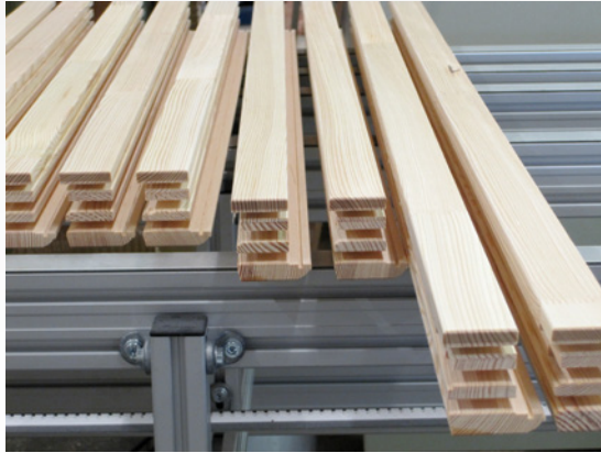
Fensterhölzer werden mit hoher Präzision ausgerichtet
