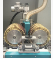
Doppelbürste im Gleichlauf und Gegenlauf schleifend
