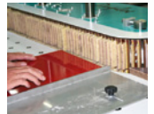
ROBA Duplex im Einsatz: Kantenschliff an Möbelfronten
