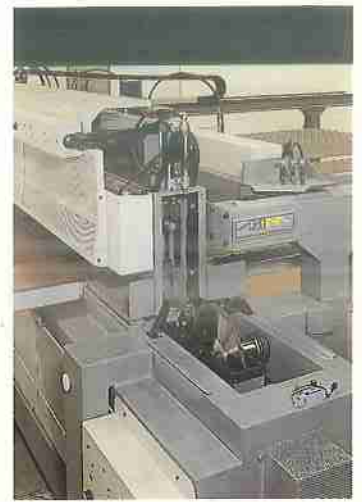
Gruppo incisore e gruppo pressore. Scoring saw and clamping beam/cylinders. Groupe graveurs - Groupe poussement. Grupo incisor - Grupo prensor. Vorritzaggregat und Drückereinheit.
