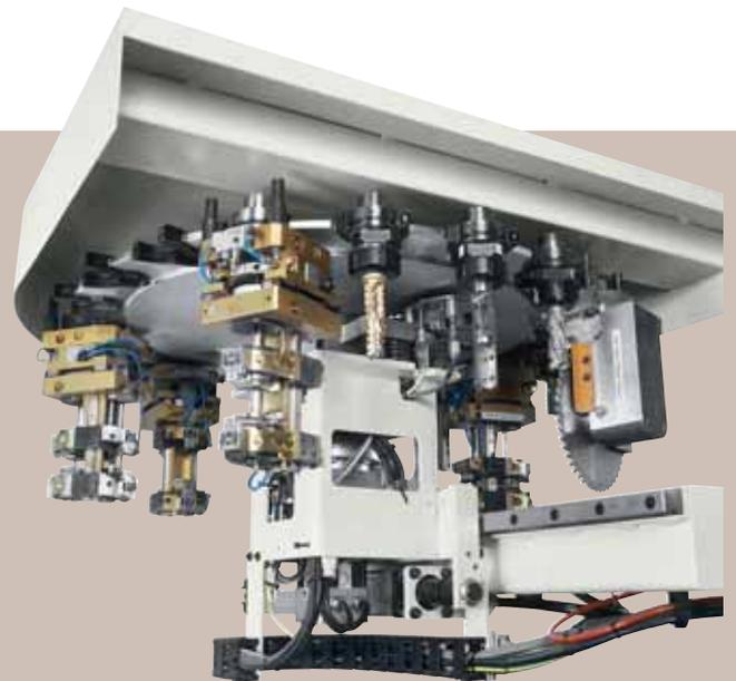
Der Werkzeugwechsel ist automatisch und erfolgt während das Bohraggregat in Betrieb ist. Dies ist möglich dank der Werkzeugmagazine mit wahlweise 10 oder 18 Positionen, die direkt auf dem Aggregateträger angebracht sind.
