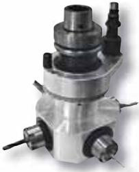
Bohraggregat für 4 Seiten waagerechte Bohrungen zum Bohren mit verschiedenen Durchmesser
