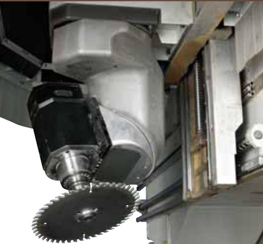
Elektrospindel "High Power" mit 4 oder 5 Achsen und 13 kW Leistung (S1) ist auf einem Träger unabhängig von dem Bohraggregat installiert und dafür ausgelegt, alle senkrechte und schräge Fräsbearbeitungen auszuführen und mit Zusatzaggregaten eine Perfekte Endbearbeitung der Kanten.
