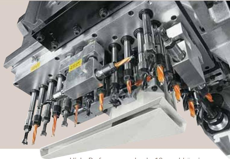
High Performance durch 18 unabhängige Vertikal- und Horizontalspindeln.
