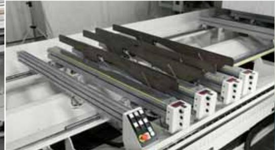
Das Morbidelli TV Arbeitstisch besteht aus Aluminium-Träger, die in Richtung X beweglich sind, innerhalb derer das Vakuum-System gefördert wird. Somit ist der gesamte Arbeitsbereich gut zugänglich und eine Beschädigung durch Abfälle oder Reststücke ist ausgeschlossen. Dieser innovativer Arbeitstisch ermöglicht eine einfache und praktische Ausrichtung und Befestigung der Werkstücke. Die Sauger können
