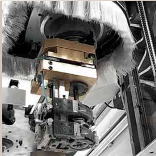
Die neueste Generation Elektroschneidspindeln mit 13kW und 4 oder 5 Achsen (Arbeitsmodus S1) für die Ausführung aller Bearbeitungen mit maximaler Präzision und hochwertiger Verarbeitung. Große Werkzeugverfügbarkeit mit einem Werkzeugwechsler mit 28 Werkzeugplätzen.
