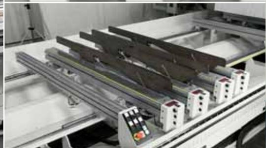
La mesa de trabajo TV-Morbidelli está constituida por soportes de aluminio, móviles en sentido X, dentro de los cuales se canaliza el sistema del vacío. De este modo, considerada la falta de canalizaciones externas, toda la superficie de la mesa está libre y sin riesgos que eventuales desechos puedan perjudicar la mesa. Esta mesa innovadora es la solución más simple y práctica para el bloqueo y la referencia de
