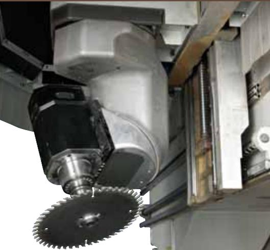
Electro porta brocas "High Power" 4 o 5 ejes con potencias de 13 kW (S1) instalado en un carro independiente desde la unidad de taladro, en grado de realizar todas las funciones de fresado vertical o inclinado y, por medio de la utilización de apropiadas cabezales, los trabajos de acabado del canto.
