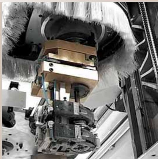
Electro porta brocas de 13 kW 4 o 5 ejes de última generación (en modalidad de trabajo S1) para realizar todos los trabajos con la máxima precisión y calidad de acabado. Gran disponibilidad de herramientas gracias a las 28 posiciones del almacén.
