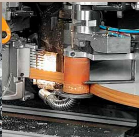
Gruppo a bordare di ultima generazione per l'applicazione della colla direttamente sul pannello.
