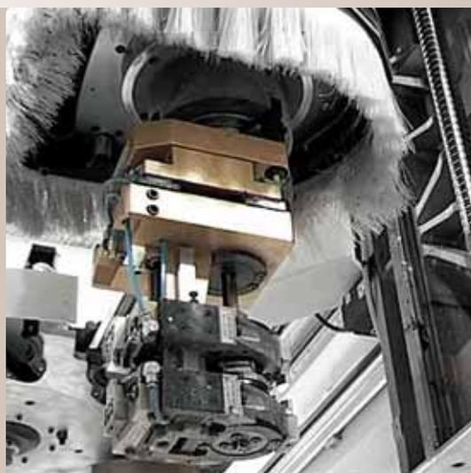
Elettromandrino da 13 kW 4 o 5 assi di ultima generazione (in modalità di lavoro S1) per eseguire tutte le lavorazioni con la massima precisione e qualità di finitura. Grande disponibilità di utensili grazie a 28 posti in magazzino.
