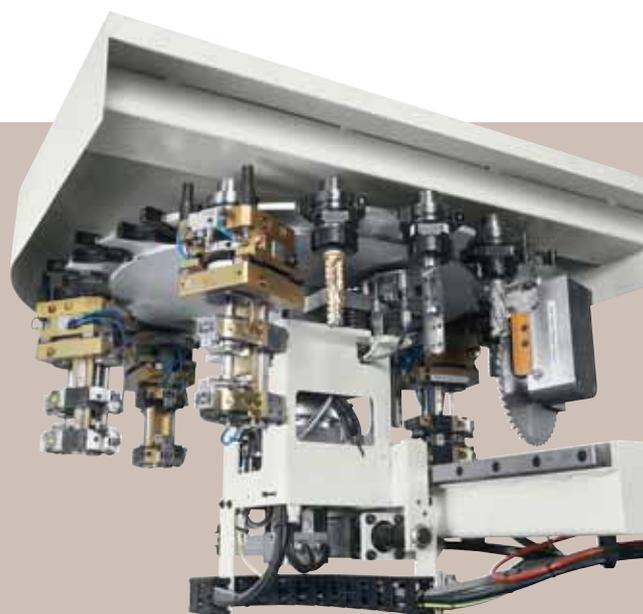
La sostituzione degli utensili è automatica e avviene in tempo mascherato, mentre l'unità di bordatura è operativa. Questo è possibile grazie ai magazzini da 10 o 18 posizioni installati direttamente a bordo macchina
