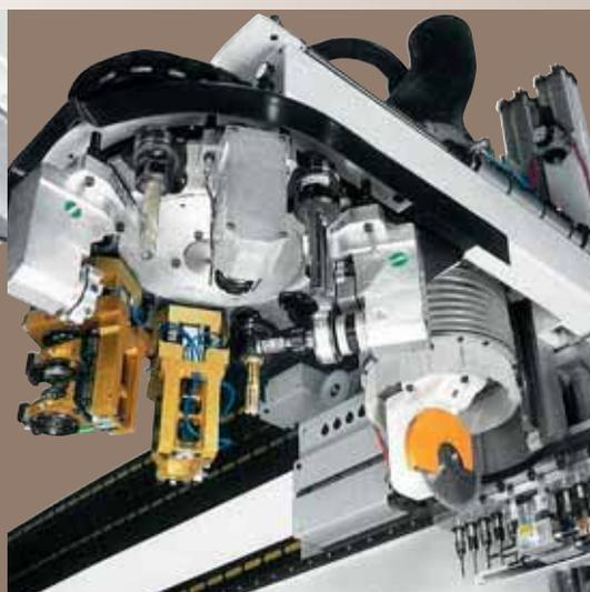
Elettromandrino di ultima generazione da 11 kW (S1) con magazzino utensili a 12 posizioni "On Board" e cambio mascherato dell'utensile.
