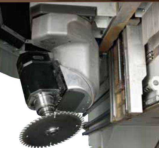
Elettromandrino "High Power" 4 o 5 assi con potenze da 13 kw (S1) montato su un carro indipendente dall'unità di foratura, in grado di svolgere tutte le funzioni di fresatura verticale o inclinata con l'utilizzo di testine per la finitura del bordo.
