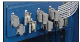
Leicht zugängliche Schlauch-/Auftragskopfanschlüsse erleichtern Installation
