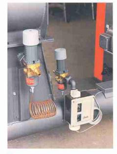
Der dreifache Rückbrandschutz gibt Sicherheit. Sicherheitsthermostat und Löscheinrichtung sind bei uns Standard.
