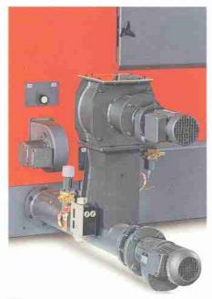
Die Beschickungseinheit mit Zellenradschleuse, Brennstoffvorlage und Stokerschnecke - die optimale Dosiertechnik für einen emissionsarmen Feuerungsbetrieb.
