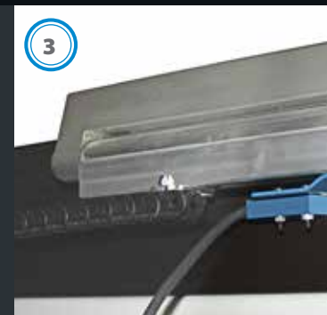
Präzise Maßfassung über Magnet-band.
