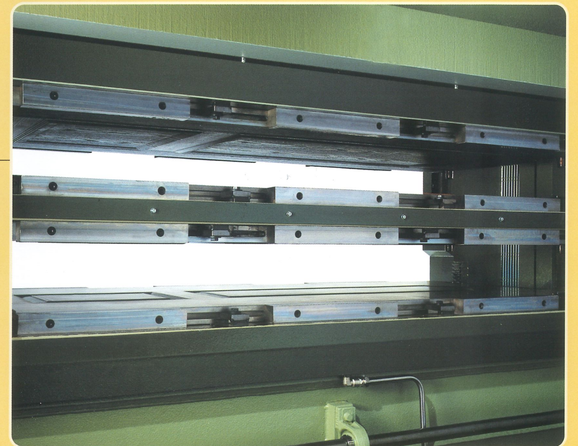
Particolare stampi per Skin door • A detail of the Skin door mould Particulier des moules pour Skin door • Detalle moldes para Skin door • Деталь прессов для Кожаной двери
