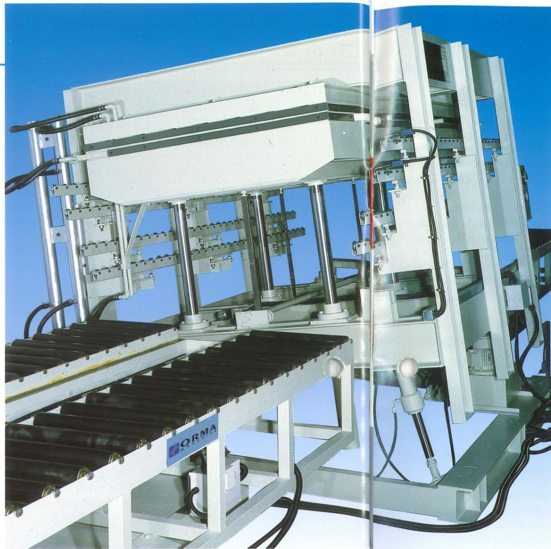
Dettaglio del sistema a estrattore/spintore dei vassoi. Si possono notare i vassoi in alluminio dotati di "anelli" di aggancio. I vassoi scorrono su dei rulli folli sulla piattaforma e su vie a rotelle per guidarli all'interno della pressa. Il sistema garantisce precisione e stabilità durante le fasi di traslazione.
