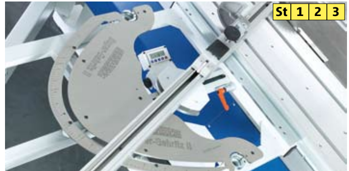
Gehrungs- und Längensschlag SUPER-GEHRFIX II stufenlose Gradeinstellung 1/100 mm durch LCD-Anzeige
