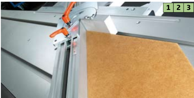
Gehrungs-Hilfsanschlag die Problemlösung beim Anlegen von spitzen und stumpfen Gehrungen
