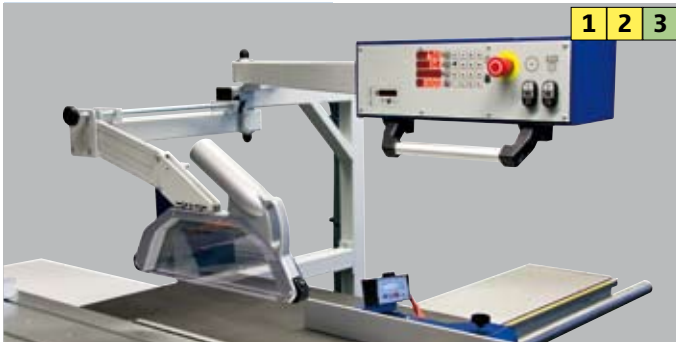
Schaltung oben mit wegschwenkbarer Schutzhaube zum Schneiden von Korpusteilen
