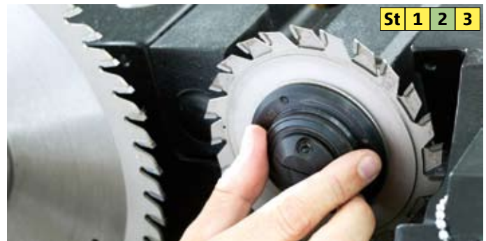
Vorritzsägeblatt QuickStep werkzeuglose Einstellung der Ritzbreite im 0,05 mm Rastersystem
