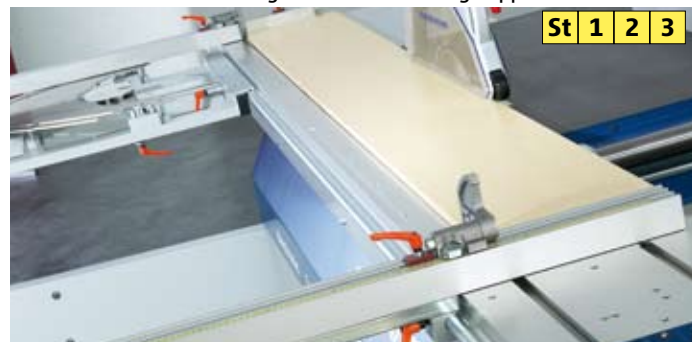
Parellenschlag links vom Sägeblatt zum Schneiden von langen und schmalen Teilen
