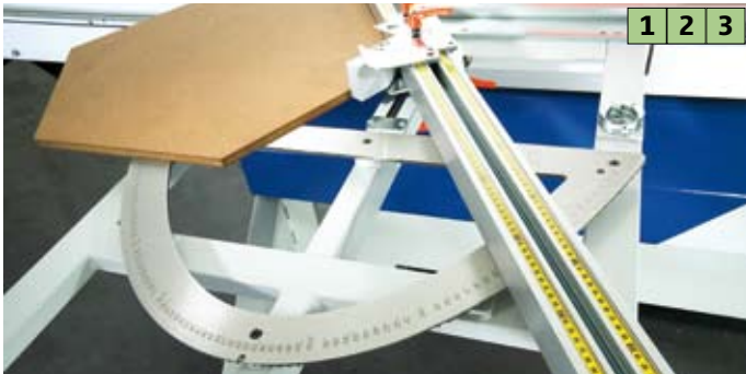
Gehrungs- und Längensschlag SUPER-GEHRFIX I mit autom. Längenausgleich
