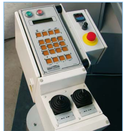
Abb. 20 NCB-2 Steuerung mit Joystick (Option)
