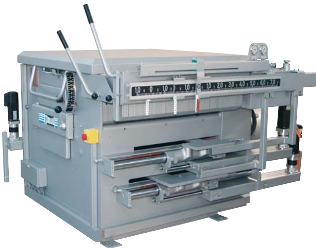
Abb. 5 KME2/1000, servomotorische Sägeblattverstellungen
