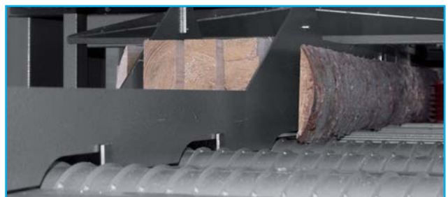
Abb. 19: Spreißelabscheider mit Trennlamelle
