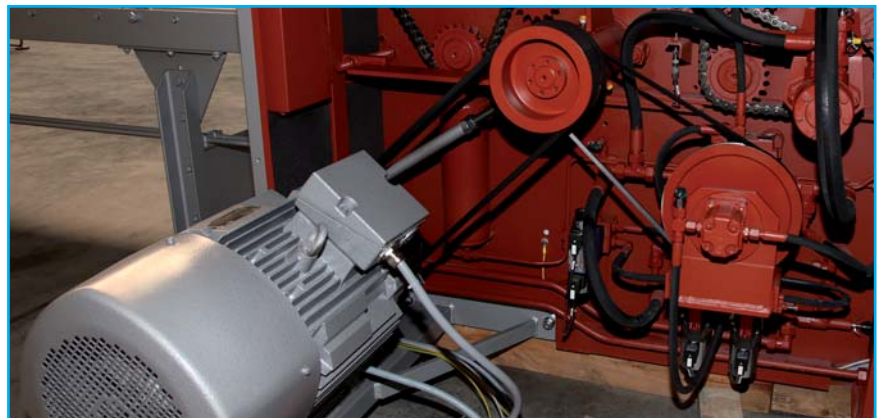
Abb. 11: Antriebsmotoren bis 75 kW treiben über Keilriemen die Sägewelle an
