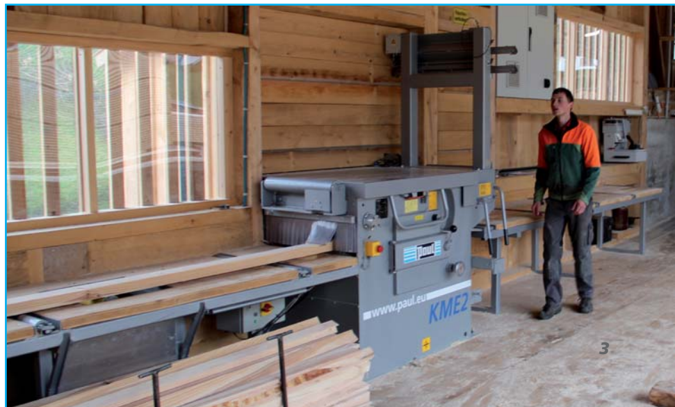
Abb. 2: KME2-750 mit manueller Beschickung im Sägewerk
