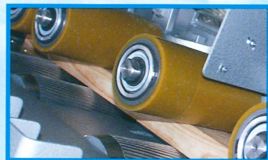
breite Vorschubwalzen garantieren eine optimale Schnittgutführung in der Kappstation
