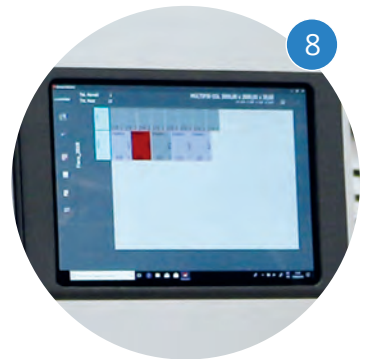
Ottimizzatore di tagli a bordo macchina Putsch Label Optimiseur des coupes à bord de la machine
