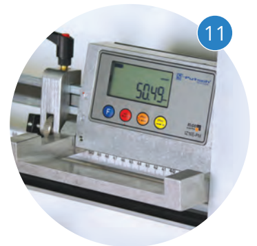
Electronic vertical measuring display Medidor digital para posición vertical
