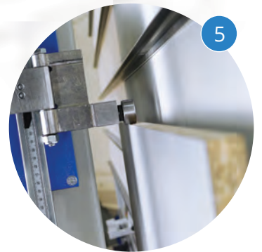
Dispositivo tagli ripetitivi in orizzontale Dispositif coupes répétitif horizontales
