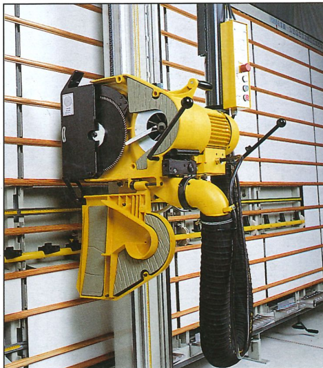
Carter coprilama aperto con insonorizzazione. Opening of blade cover with soundproof system. - Offener Sägeschutz mit Schalldämmung. - Tapa porta-hoja abierta con sistema de insonorización. - Unité de sciage ouverte avec système d'insonorisation.
