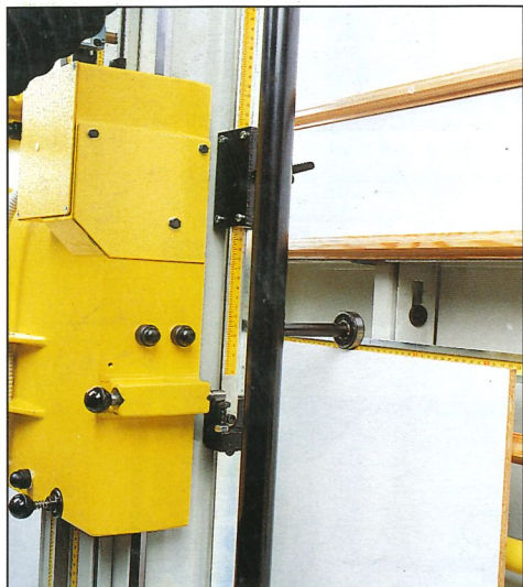
Dispositivo taglio a strisce orizzontali. - Repeat cutting device of horizontal strips. - Waagrechter Streifenanschlag. - Corte tiras horizontales. - Dispositif pour coupes horizontales répétitives.
