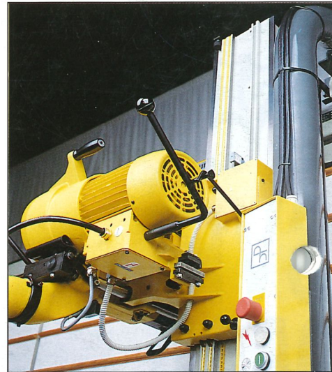
Dispositivo per l'ingresso della lama in posizione alta. Device to allow the entering of the blade in high position. - Eintauchvorrichtung in hoher Position. - Dispositivo que permite l'entrada de la hoja en posición alta. - Dispositif pour permettre l'entrée de la scie dans la position haute.
