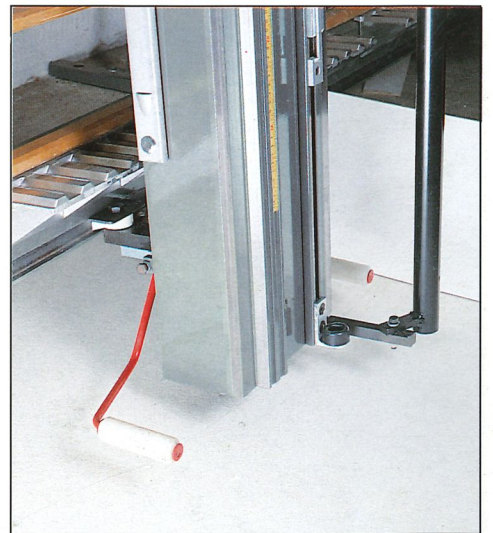
SVP 950 A Systeme de securité barre sensible arrêt poutre (standard).
