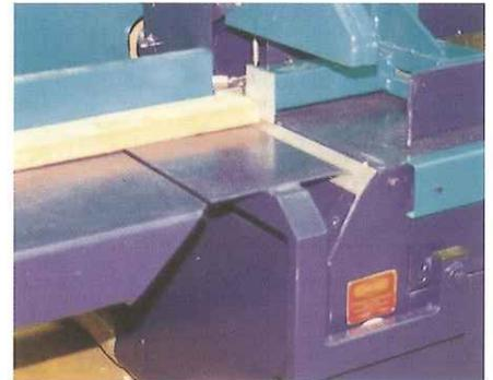
Abfallstücke fallen direkt am Sägeblatt über die Abfallklappe nach unten auf ein Transportband. Gutstücke gelangen sicher über den Abfallschacht.
