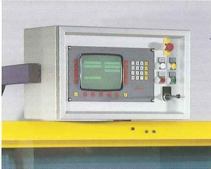
Mit der benutzerfreundlichen Steuerung CONTROL 5.0 kann man für jeden Anwendungsfall die optimale Ausbaustufe wählen: Vom Einzel- / Programmzuschnitt bis zur Volloptimierung mit Strichmarkierung steht Ihnen mit CONTROL 5.0 die gesamte Breite der Steuerungsmöglichkeiten für individuelle Anwendungen zur Verfügung.
