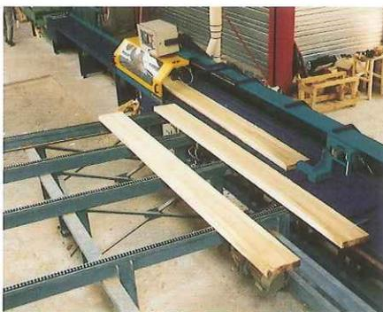
Vollautomatische Beschickung der Kappanlage über einen Kettenquerförderer
