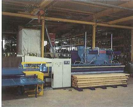
Vollautomatische Beschickung der Kappsäge durch einen Vakuum-Umsetzer
