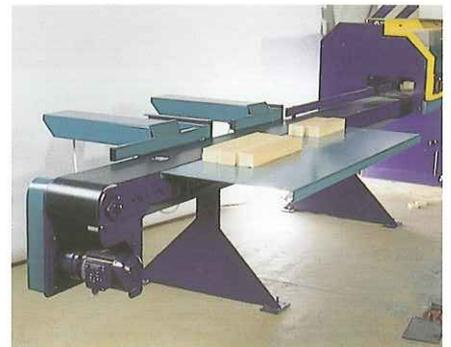
Die Abschnitte werden automatisch durch robuste, mehrfach geführte pneumatische Abschieber ausgeschoben bzw. sortiert.
