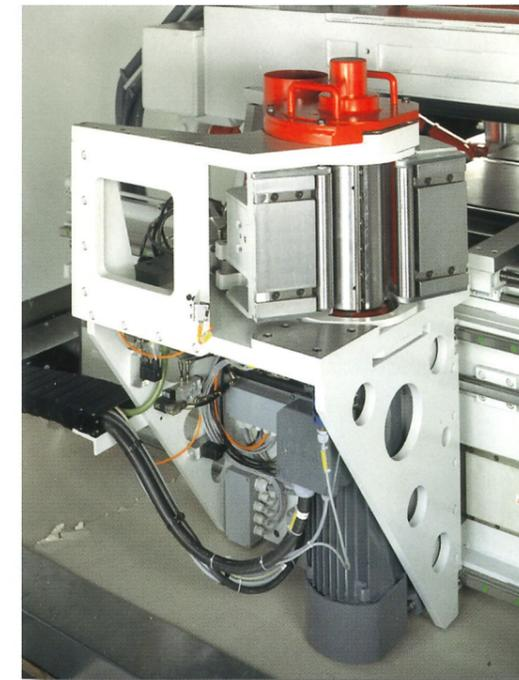
Um auch gerade Werkstücke hobeln zu können, wird die Tasteinrichtung an der Einlaufseite der linken Spindel auf pneumatisch federnden Betrieb umgeschaltet.
